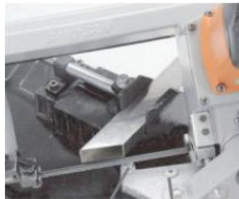
При резке под углом 45° необходимо ослабить болт 1 и болт 2, повернуть основание выравнивания угла резания, затем зафиксировать болты и начать работу по резке.
