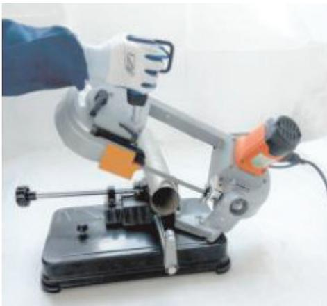
Запустите двигатель. Когда ленточное полотно достигнет полной скорости, опустите полотно на заготовку.
