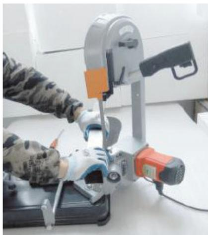
Если заготовку нужно вырезать вдоль по длине, поставьте раму станка вертикально. Запустите двигатель.
