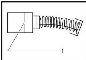
Регулярно извлекайте и проверяйте угольные щетки. Замените, когда они износятся до предельной отметки.
